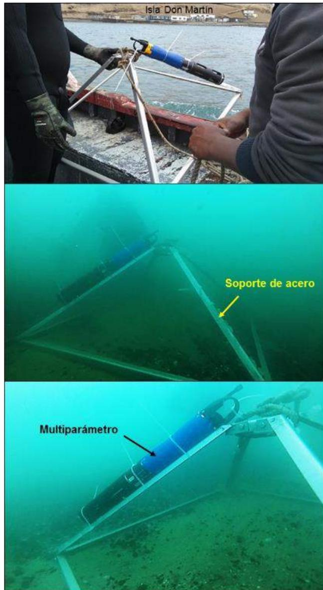
Figura 4. Instalación de la sonda multiparámetro en el fondo marino de la isla Don Martín.
