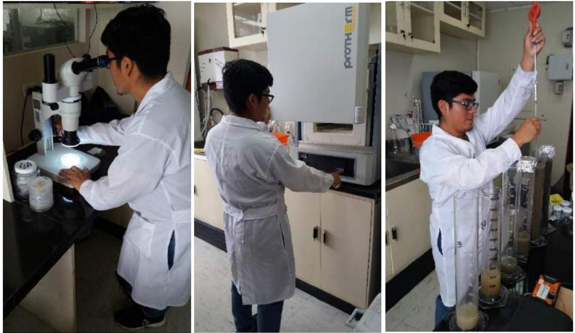
Figura 11a. Descripción de componentes del sedimento, Análisis de la fracción fina mediante método de la pipeta, Análisis del contenido de materia orgánica y carbonatos empleando una mufla.
