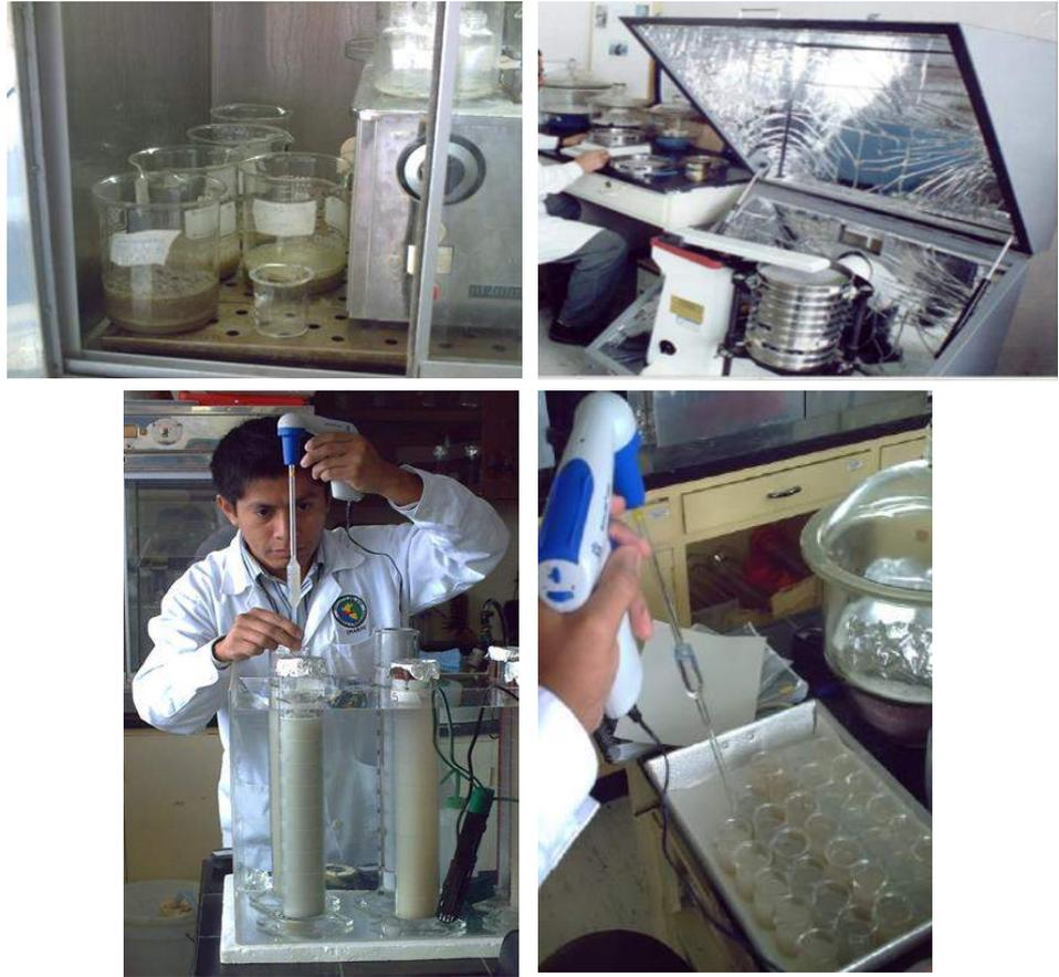
Figura 73a Pre-Tratamiento de muestras con peróxido de hidrógeno, análisis granulométrico de la fracción gruesa por tamizado; Análisis de la fracción fina mediante método de la pipeta.
