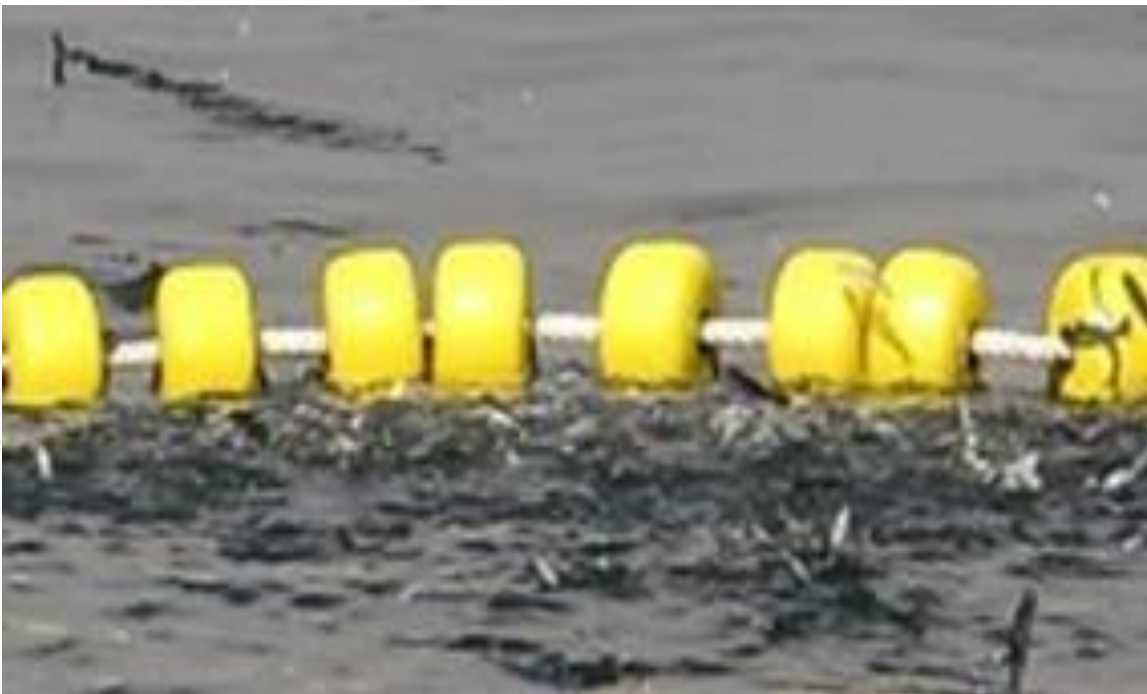
Figura 9: Escape de ejemplares por los dispositivos selectores de cardumen del lateral de flotadores. Red HEXDSC (SOLEMAR)
