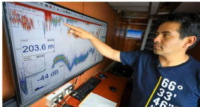
Figura 34 Ecograma indicando concentraciones de peces, en caso de anchoveta, ubicadas a nivel superficial
