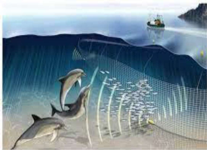
Fig.1. Alarmas acústicas utilizadas en redes de enmalle
