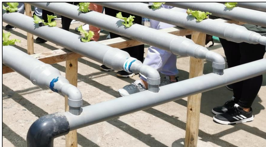
Figura 35. Imagen real del mecanismo de conducción de retorno de la SN al tanque o reservorio.
