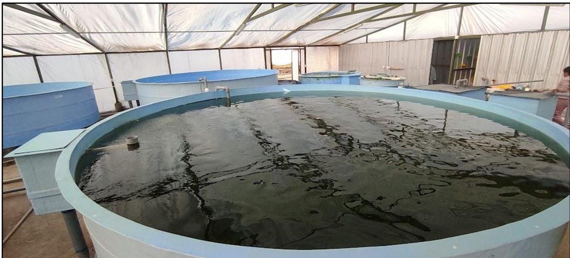
Figura 16. Tanques para cultivo de peces, circulares y cuadrados, fabricados en fibra de vidrio.
